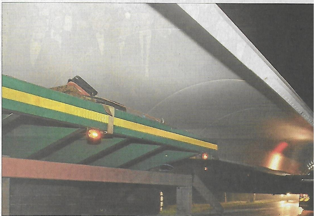
Vier Zwillingsreifenpaare vorn, vier Zwillingsreifenpaare hinten – dazwischen rund 70 Meter. In der Mitte wird die Basis des Windradmasts zusammengesraubt.
